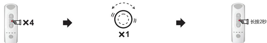
1) 当电机在停止状态时, 短按发射器停止键4次。
