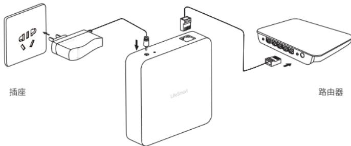
智慧中心连接好网线、接通电源后，8 - 10秒钟网口灯开始亮起并闪烁；15秒左右智慧中心面板上的指示灯开始闪烁（表示正在连接网络），直至常亮（表示成功连接）。
